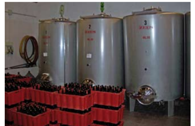
Serbatoi che accolgono il Brunello vendemmia 2008. Il freddo invernale farà depositare i tartrati naturalmente, poi il vino andrà in botte
